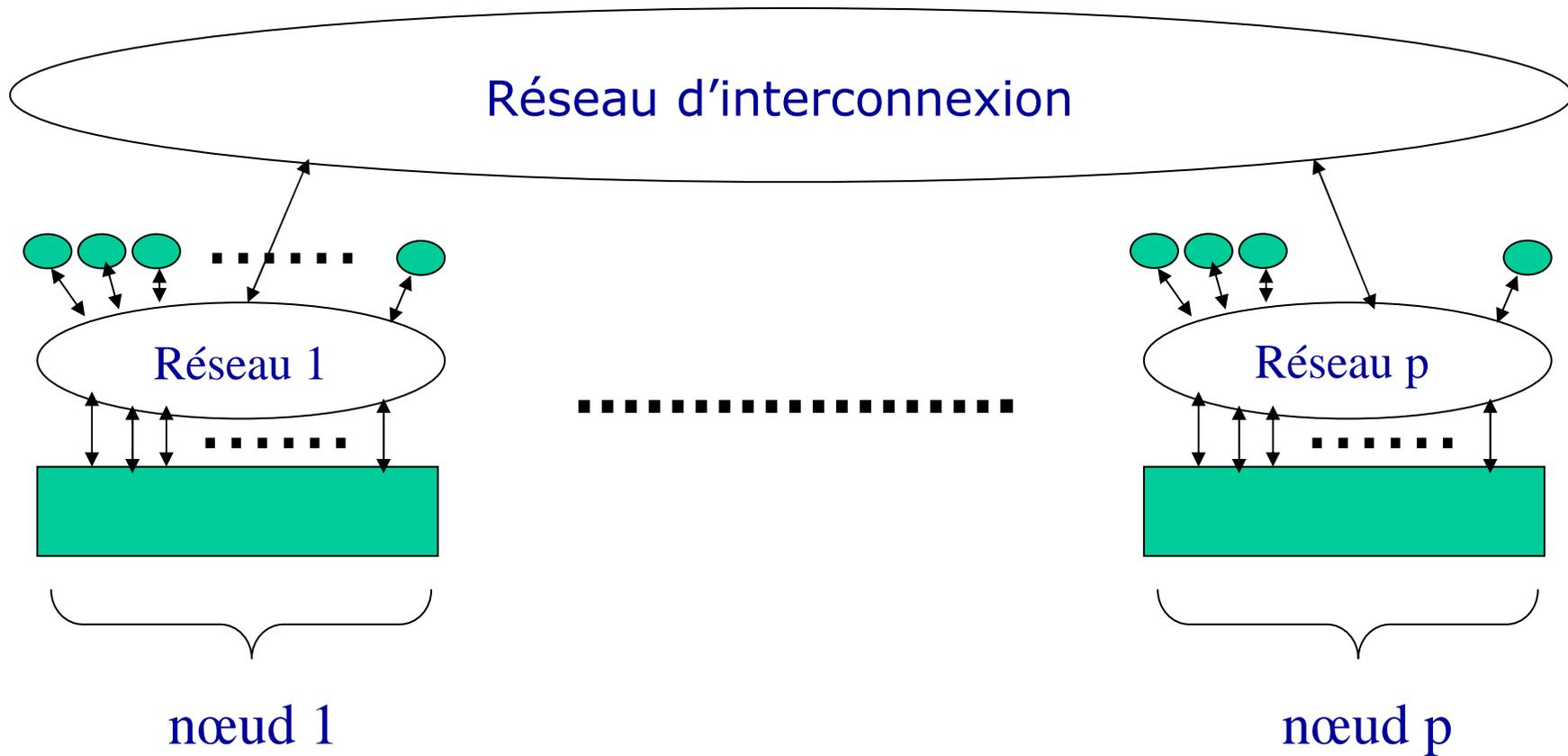
IBM SP4 par exemple, programmation en MPI et/ou OpenMP principalement
