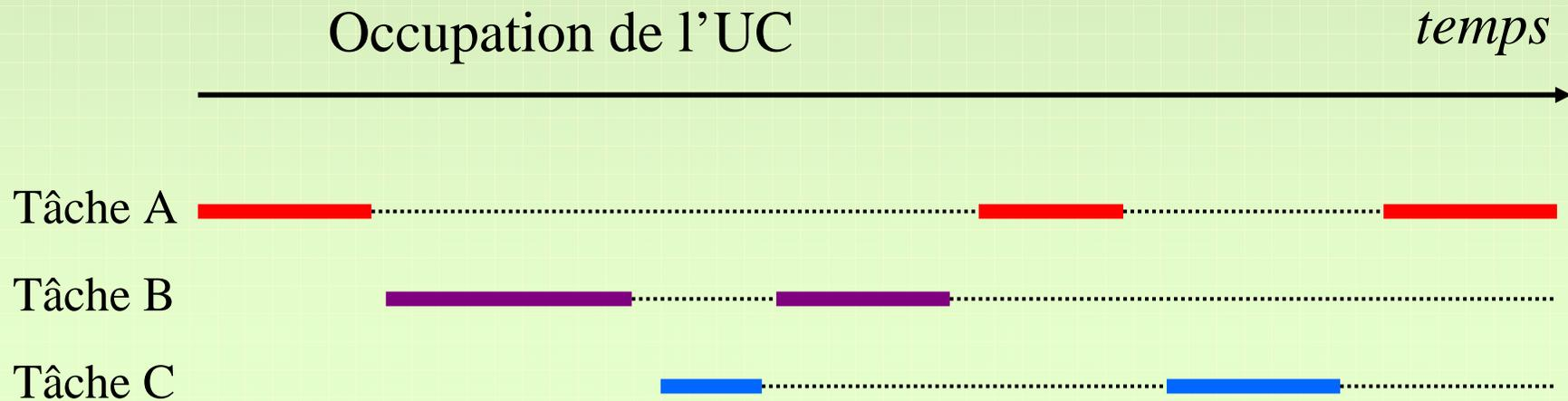
Une seule tâche est allouée à la fois à l'UC par le scheduler, sauf dans le cas de processeur disposant de l'hyperthreading (comme INTEL 2600, 2800, 3000 MHz)
